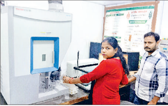
नारनौल। किसान द्वारा लाई गई मिट्टी को सैंपल के लिए तैयार करते हुए तथा आईसीपी मशीन पर मिट्टी परीक्षण करते हुए।
